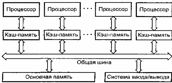
Рисунок 7.14 – Структура SMP-системы с общей шиной
