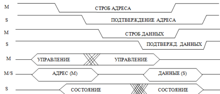
Рисунок 4.16 – Чтение на асинхронной шине
