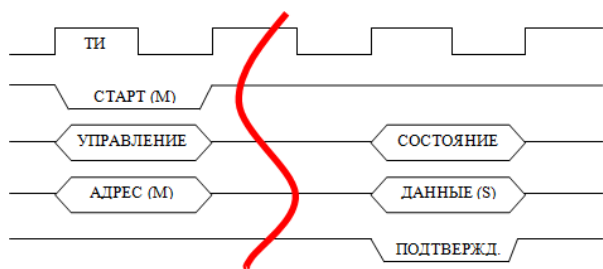
Рисунок 4.15 – Чтение на синхронной шине
