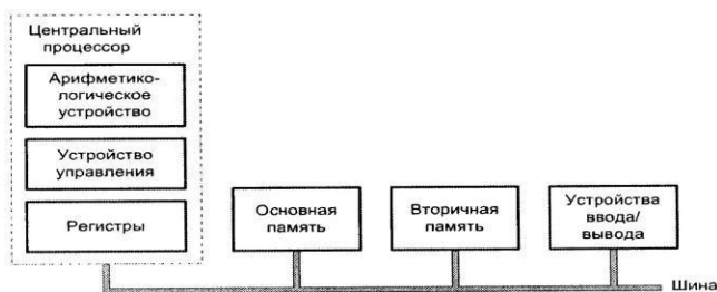
Рисунок 1.2 – Структура ВМ на базе общей шины
