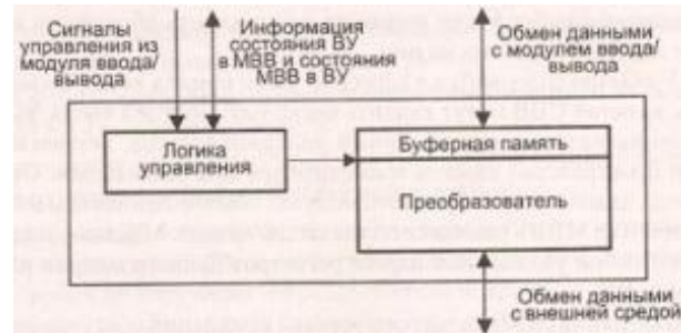
Рисунок 6.3 – Структура внешнего устройства
