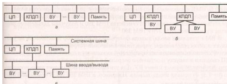
Рисунок 6.9 – Возможные конфигурации систем прямого доступа к памяти
