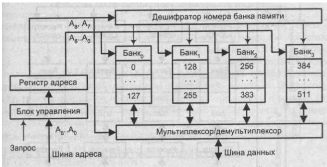
Рисунок 5.2 – Структура основной памяти на основе блочной схемы
