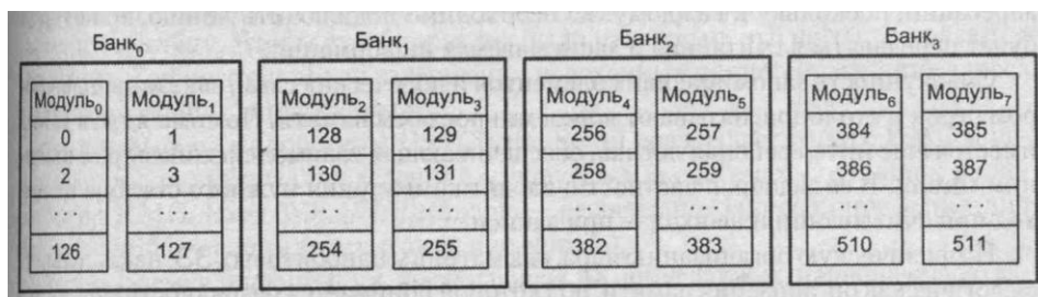
Рисунок 5.4 – Блочно-циклическая схема расслоения памяти
