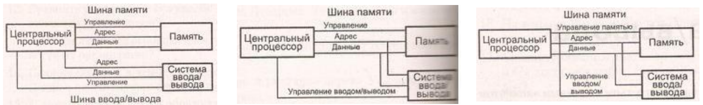
Рисунок 6.1 – Способы подключения СВВ к ядру процессора
